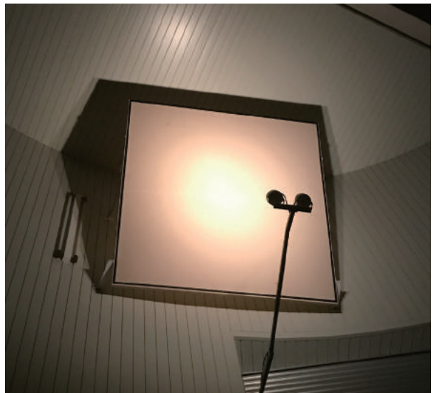
画像 1：写真中央のロッドの先端に取り付けられた旧ドームフラットランプでスクリーンを照らした様子。一箇所から照らしているため、スクリーンの中心部は明るい周縁部は暗く輝度ムラがある。
