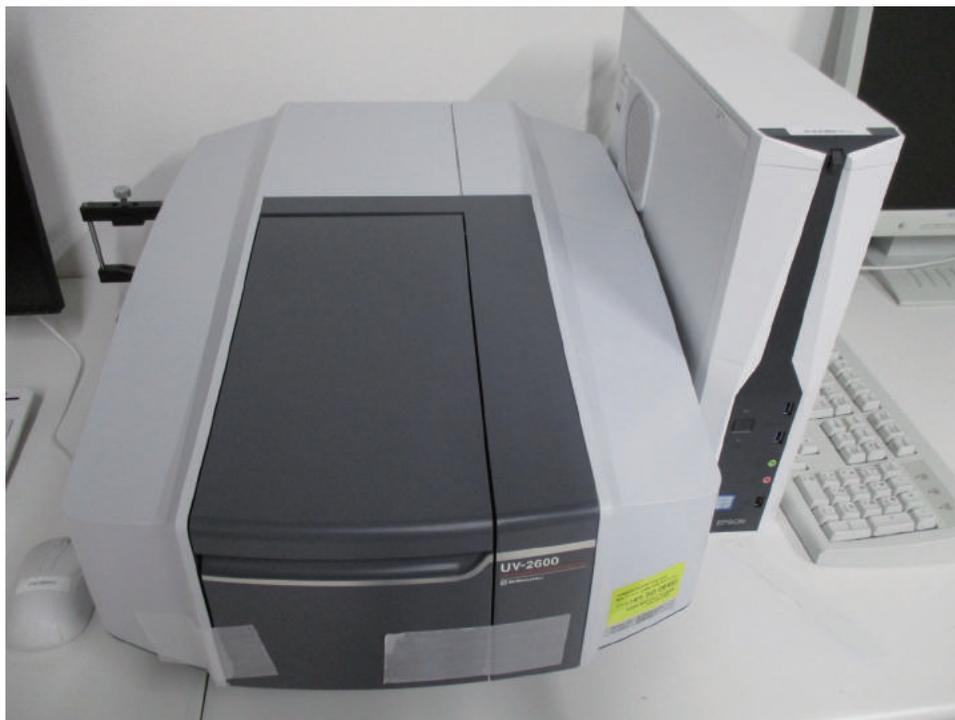
図 1: 偏光度が測定できるように改良した分光光度計 UV-2600。真ん中の黒い部分に測定試料を入れます。
