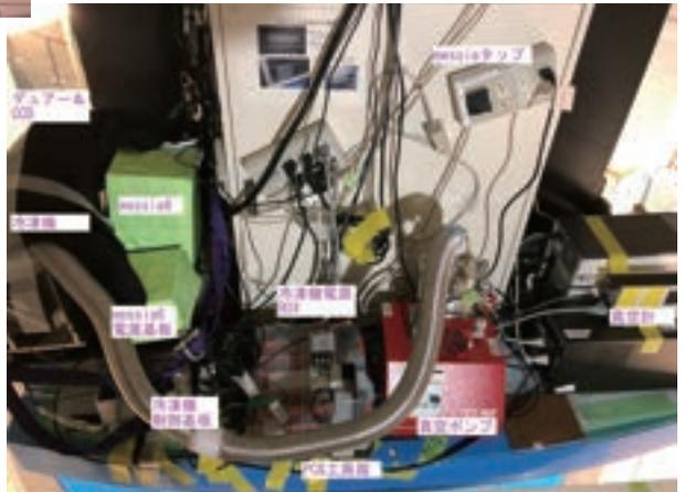
図 5：新 CCD カメラとそれに必要な機器を配置した様子。ケーブルや機器が乱雑に設置されお世辞にも綺麗とは言えないが、この写真の配置でないとノイズ量が目標値を下回らないので困ったもの。
