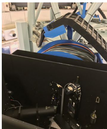
望遠鏡のすぐ横(ナスミス焦点)に設置されている観測装置 MALLS の内部。新しい装置の開発や改良を通して、これからの西はりま天文台・なゆた望遠鏡を考えています。
