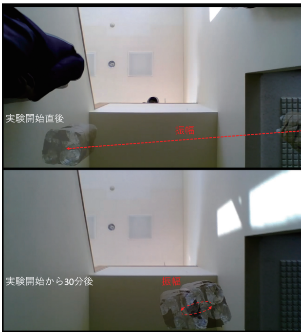
図 4：振り子の真下から見た開始直後と 30 分後の振れ幅の比較（生徒の撮影した動画から抽出）
