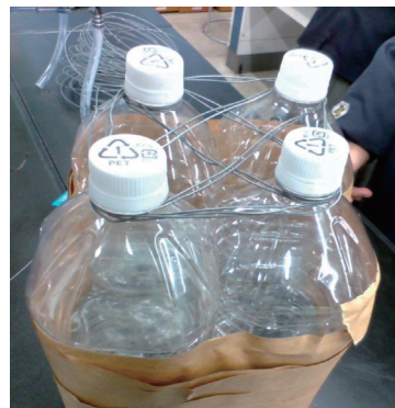
図3：ペットボトルを束ねて自作したオモリ（年度末の発表スライドより抜粋）
