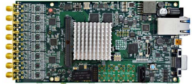
特電 Cosmo-Z 基盤 利用予定のZYNC + ADCの システム
