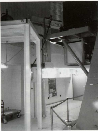
Fig. 16. メンテナンス台。ナスミス台、クレーンの位置関係がわかる
