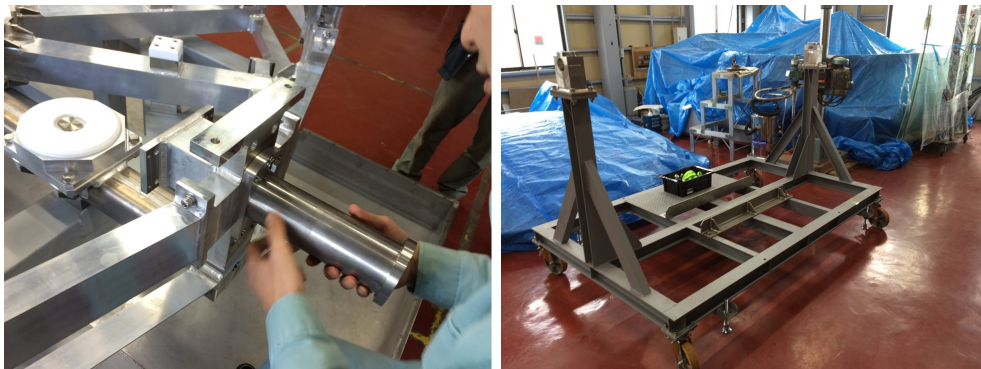
Fig. 4. (左) 主鏡治具に取り付ける耳軸。これを軸として主鏡を立てる動作を行う。(右) 回転台。左手前と右奥部に耳軸を取り付ける箇所が見える。
