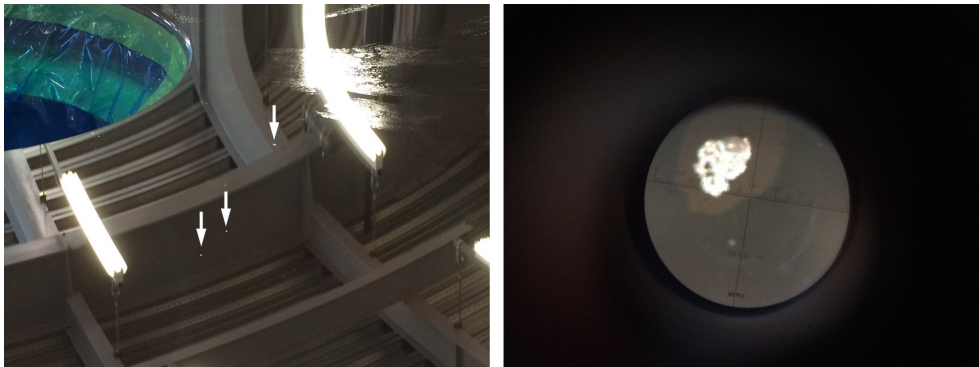
Fig. 7. (左) 主鏡鏡面に残った点状の汚れ。矢印の先に汚れがある。(右) 拡大鏡で汚れを観察したもの。光沢のある塊であることから、アルミニウムの滴であると考えられる。この図で示した汚れが鏡面状で最も大きな汚れで、大きさは0.5-1mm程度である。
