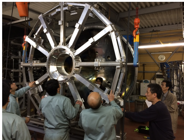
Fig. 8. レールに設置された主鏡治具。このように立てた状態で、左側にある蒸着装置内へ導入する。なおこれはリハーサル時の写真であるため、主鏡は治具に収まっていない。
