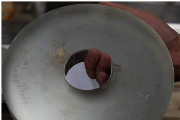
Fig. 7. 飛騨天文台の場所選定の際に使用されたカセグレン鏡。裏面には「Kyoto Nishimura Fl=1203 m/m [sic] 4.3 March'64 No 466 SN」の刻印（2019年8月27日飛騨天文台にて撮影）
