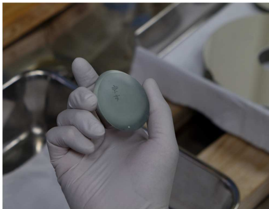
Fig. 5. 主鏡と斜鏡。主鏡には「Kyoto Nishimura F.L. = 1580 m/m, May 1964, No 472 S.N.」「京女」と書かれている。また斜鏡には「京女」と書き込まれている。
