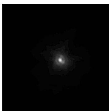
なゆた望遠鏡の回折像（良像平均：0.1秒角）
